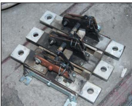
Вот причина произошедшей на подстанции аварии — выгоревший шинный разъединитель
